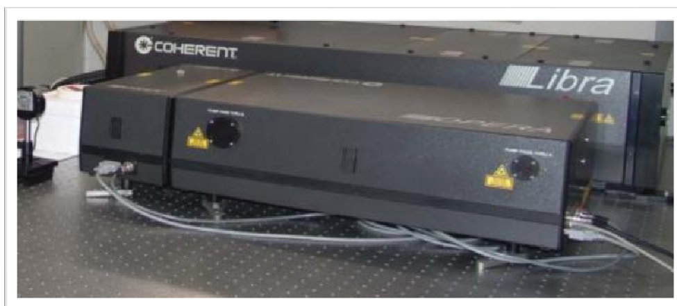
Figura 3.5 – Laser de Ti:Safira (largura de pulso: 70 fs)
