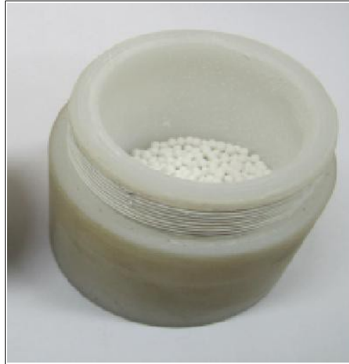
Figura 2.4 Recipiente de Polietileno Altamente Endurecido e bilhas de oxido de Zircônio.
