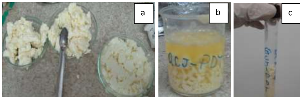
Figura 29- Procedimentos de análise. a) queijo coalho; b) Queijo emergido em Sal de Curcumina; c) Queijo em tubo de ensaio a ser exposto em luz de 450 nm.
