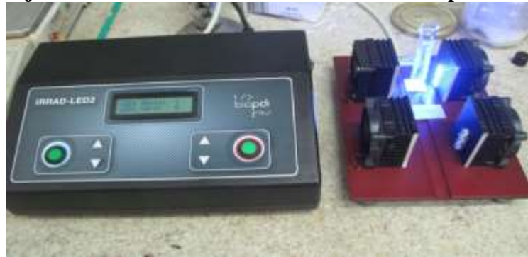
Figura 26- Conjunto de LEDs emitindo em 450 nm irradiando proveta com bactérias.
