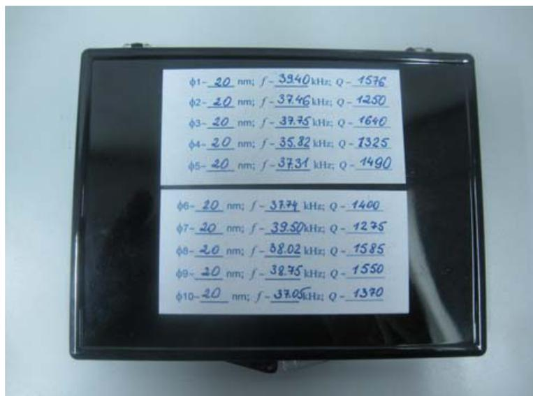
Figura 2.9: Parâmetros das Ponteiros de AFM.
