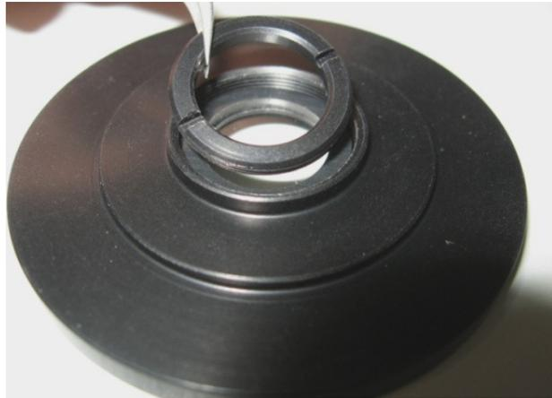
Figura 2.35: Modo de como é inserido o anel de plástico na célula líquida.
