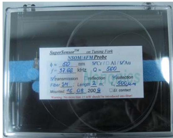
Figura 2.37: Ponteira de SNOM indicando tamanho, frequência de ressonância, fator de qualidade, etc.
