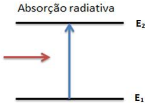
Figura 4.1- Representação de um processo de absorção.
