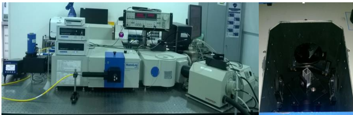
Figura 2.8- Sistema detector utilizado para estudo de luminescência.
