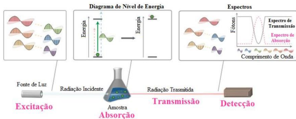
Figura 4: Diagrama esquemático de uma medida de espectro de absorção. (CHUI,2020)
