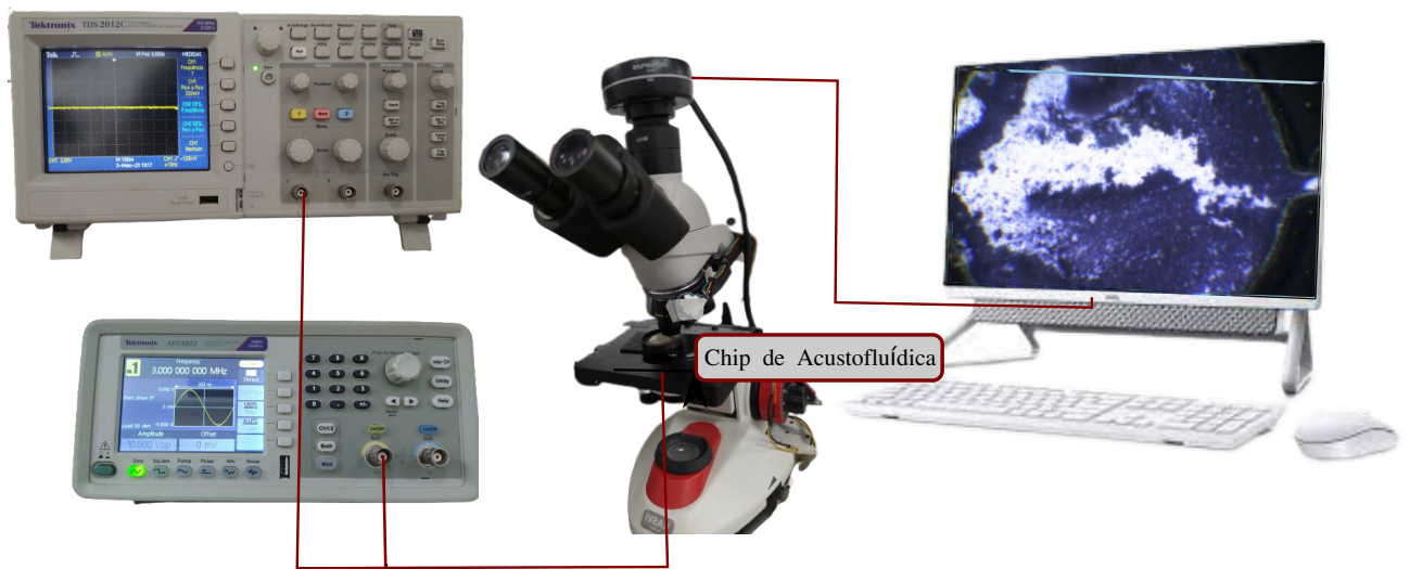
Figura 4.2: Configuração instrumental acústica utilizada nos ensaios de imunoaglutinação no chip de acustofluídica.
