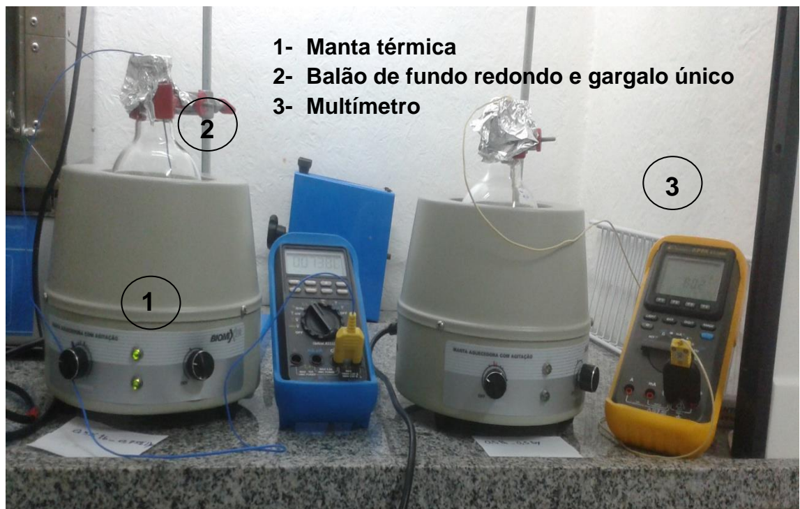
Figura 10- Imagem da rota de síntese dos nanocristais de \text{LaF}_3 pelo método de coprecipitação por via úmida.
