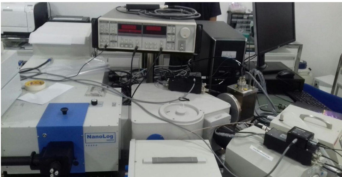
Figura 13- Parte externa do sistema detector utilizado para estudo de luminescência.
