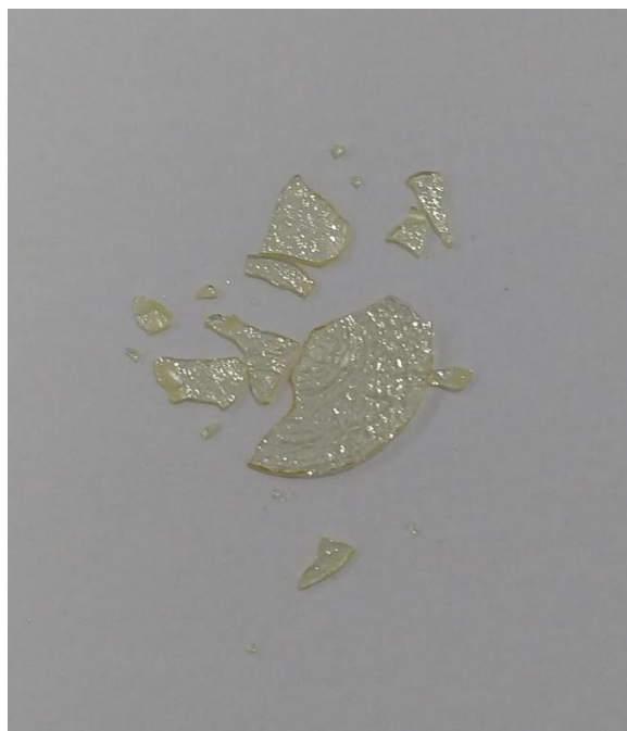
Figura 2.5: Fósforo metagermanato de chumbo dopado com Dy 3+ .
