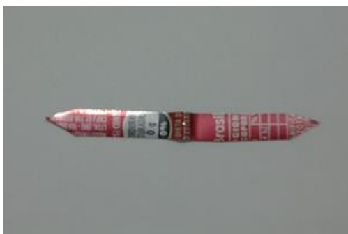
Figura 2: agulha feita com lata de refrigerante para o versorium .
