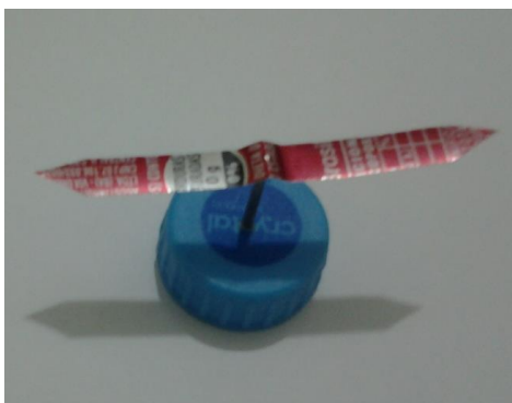
Figura 4: versorium construído com materiais de baixo custo
