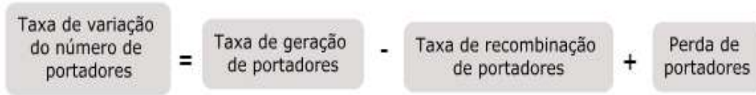
Figura 18 — Esquema da conservação de portadores no semiconductor.
