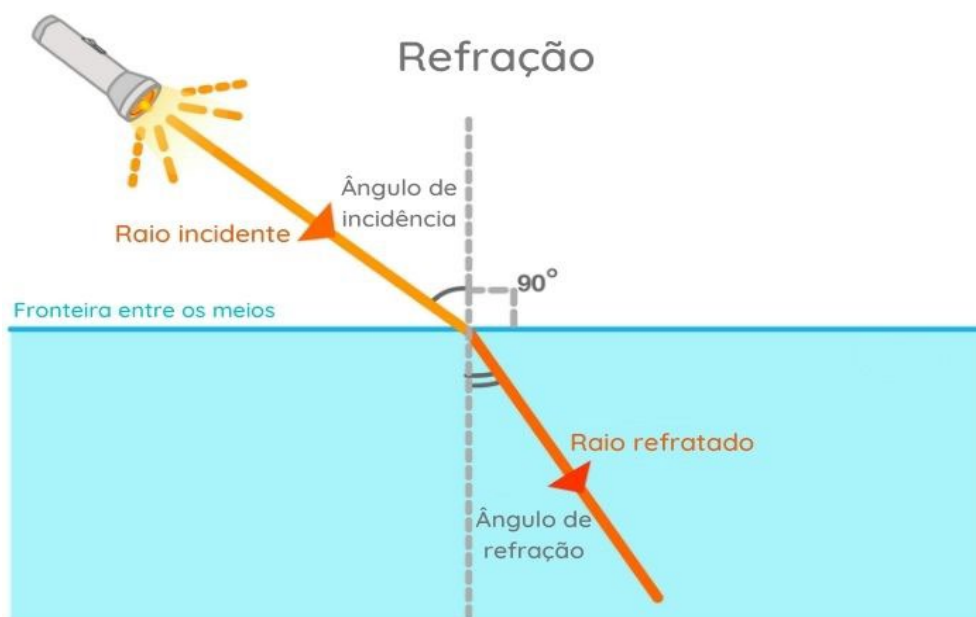
Figura 1 – descrição geométrica da lei da refração
