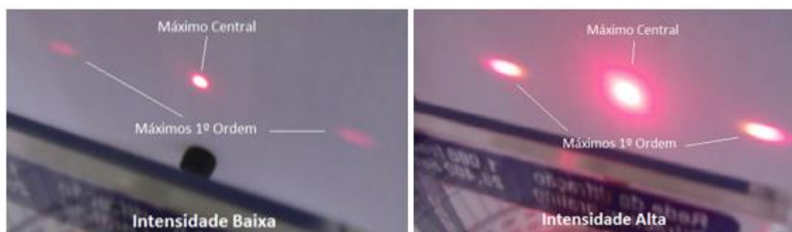
Figura 44 - Intensidade dos máximos de difração no Espectrômetro
