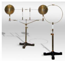
Figura 6 – Experimento de Hertz para demonstrar a existência das ondas eletromagnéticas
