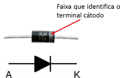
Figura 16 – Representação esquemática de um diodo semiconductor
