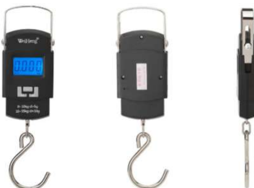
Imagem 7. Balanças portáteis digitais com gancho utilizadas na Atividade Experimental 4.
