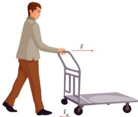
Figura 28. Quando a força aplicada ( \vec{F} ) no carrinho é superior à força de atrito ( \vec{F}_{at} ) entre o carrinho e o solo, este move-se com aceleração constante. Os elementos não estão representados em proporção. Cores fictícias.
