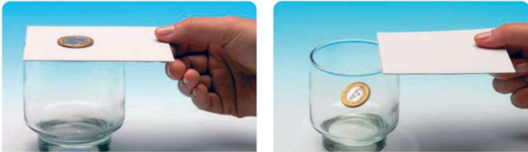
Imagem 2. A moeda cai devido à inércia, após a placa ser retirada rapidamente.
