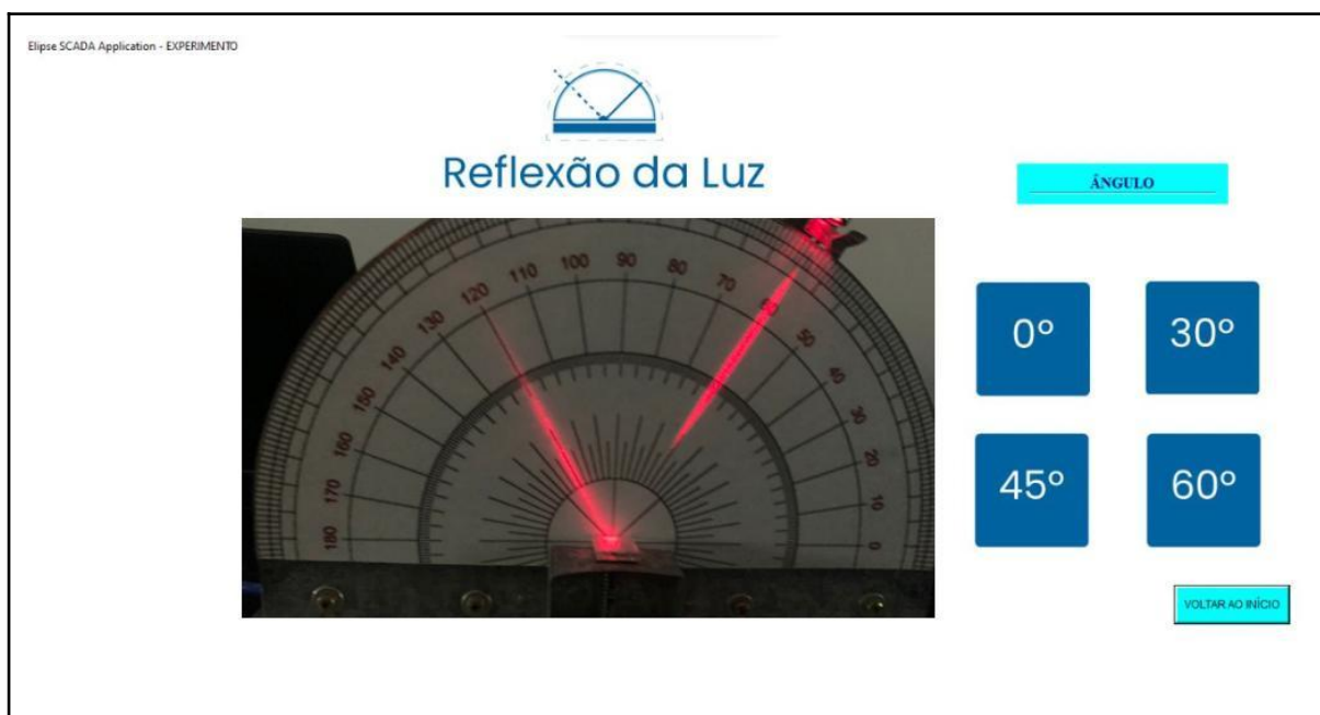
Figura 6 - Representação da tela do experimento com o laser apontando 60° com a superfície
